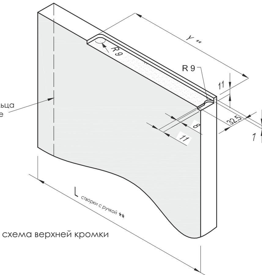
схема верхней кромки
